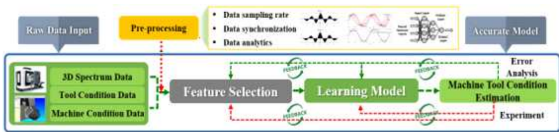
〈그림 5〉 가공 공정 모니터링/진단 기술 데이터 플로우
