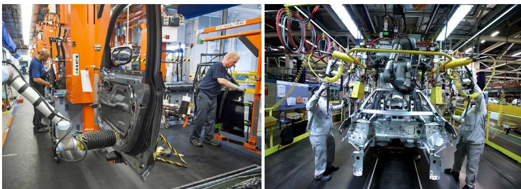
[그림 1] 자동차 제조에 사용되고 있는 협동 로봇
